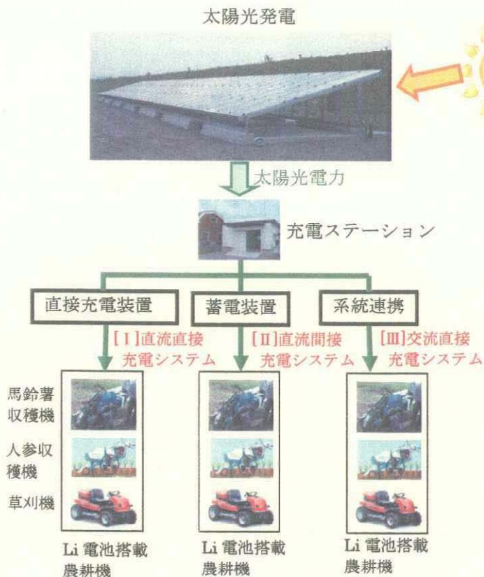
図1 諫干で実証中の太陽光電力充電方式
